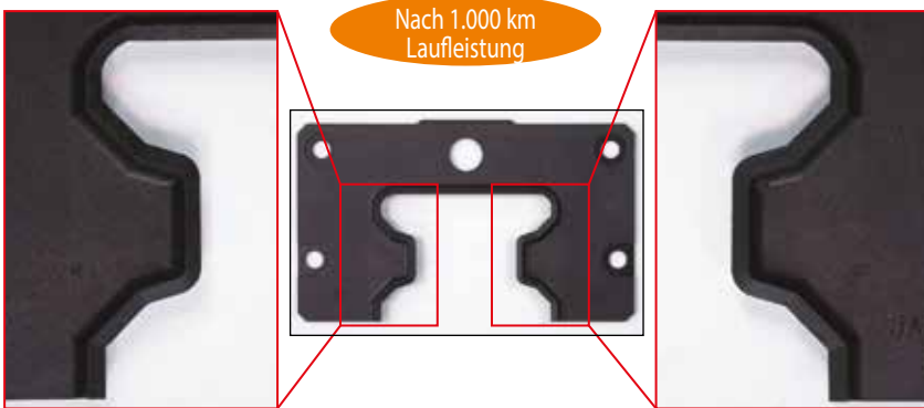
Enddichtung nicht beschädigt.
